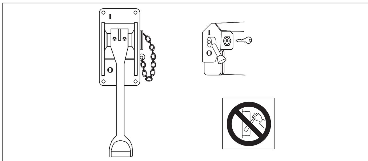
Figura 5 - Ejemplos de sistemas de enclavamiento y señal de prohibido maniobrar.
