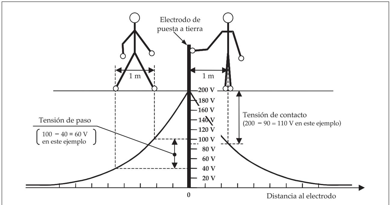
Figura 11 - Tensiones de paso y contacto.
