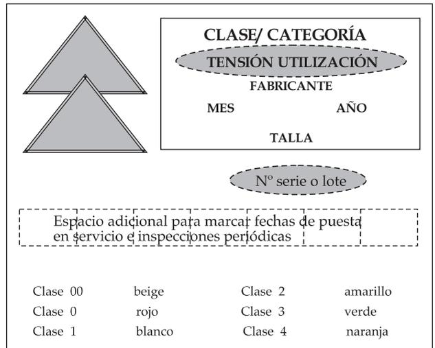
ciones y controles periódicos se marcan mediante perforaciones que deberán situarse a 20 mm como máximo de la periferia de la bocamanga (esta banda perforada no se admite en guantes de las Clases 3 y 4) o bien,
