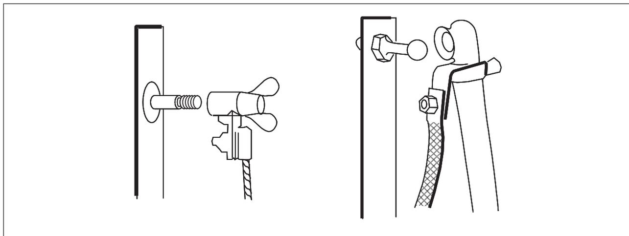
Figura 12 - Puntos fijos de puesta a tierra.
